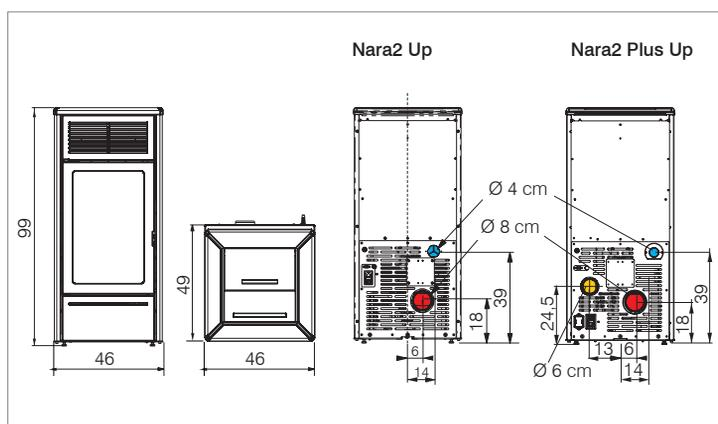
● Sortie de fumées ● Prise d'air externe ● Sortie air canalisable
