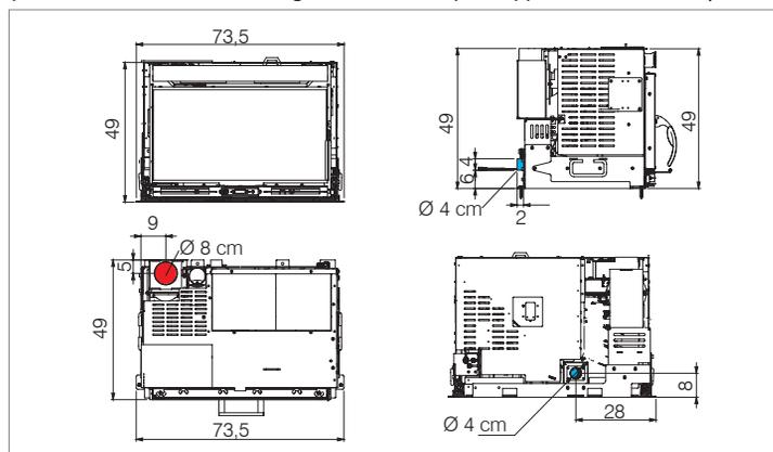
● Sortie fumées ● Prise d'air externe ● Sortie air canalisable
